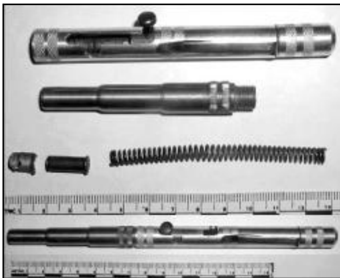
Рис. 1. Огнестрельное оружие типа однозарядного пистолета-«авторучки», калибром 5,6 мм — общий вид и разобранное состояние.
